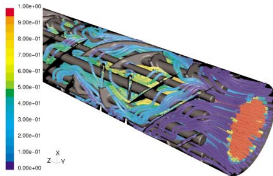
Fig. 5: Calcolo per elementi finiti (flusso laminare)
